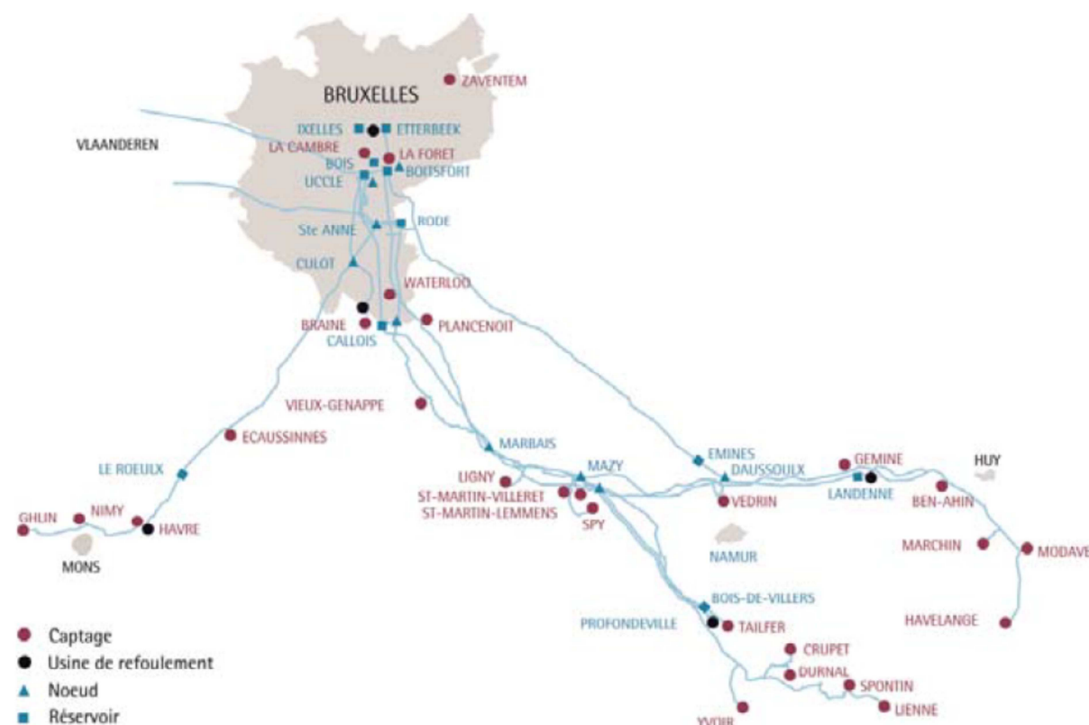
Figure 6.2 : Synoptique des grandes lignes d'adduction de VIVAQUA
